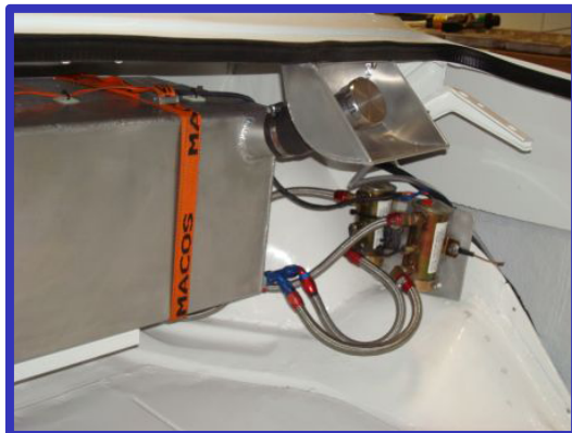
Réservoir d'essence sécurité, aviation dans le coffre de l'OPEL
